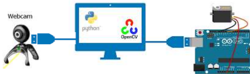
Figura 4. Hardware para el reconocimiento facial integrado con un Arduino.
