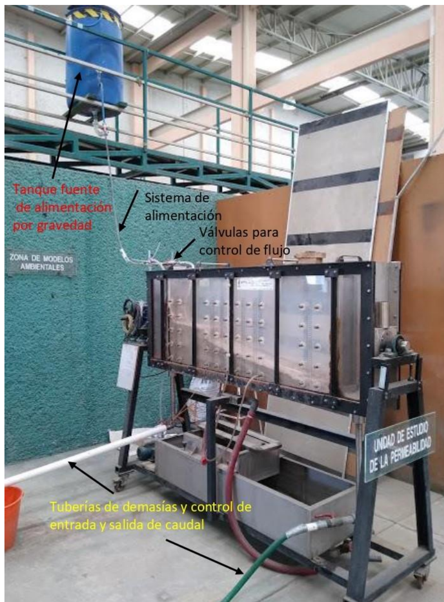
Figura 1. Estructura general de la Unidad de Estudio de Permeabilidad.
