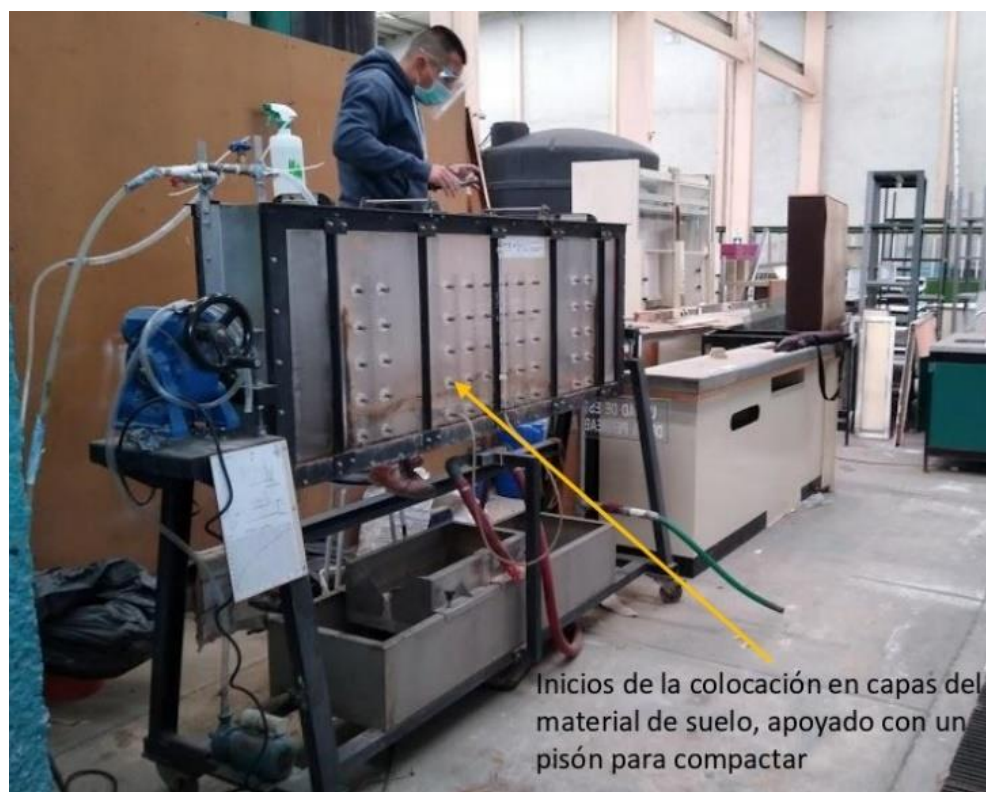
Figura 2. Preparación del perfil de medio poroso y accesorios del equipo.
