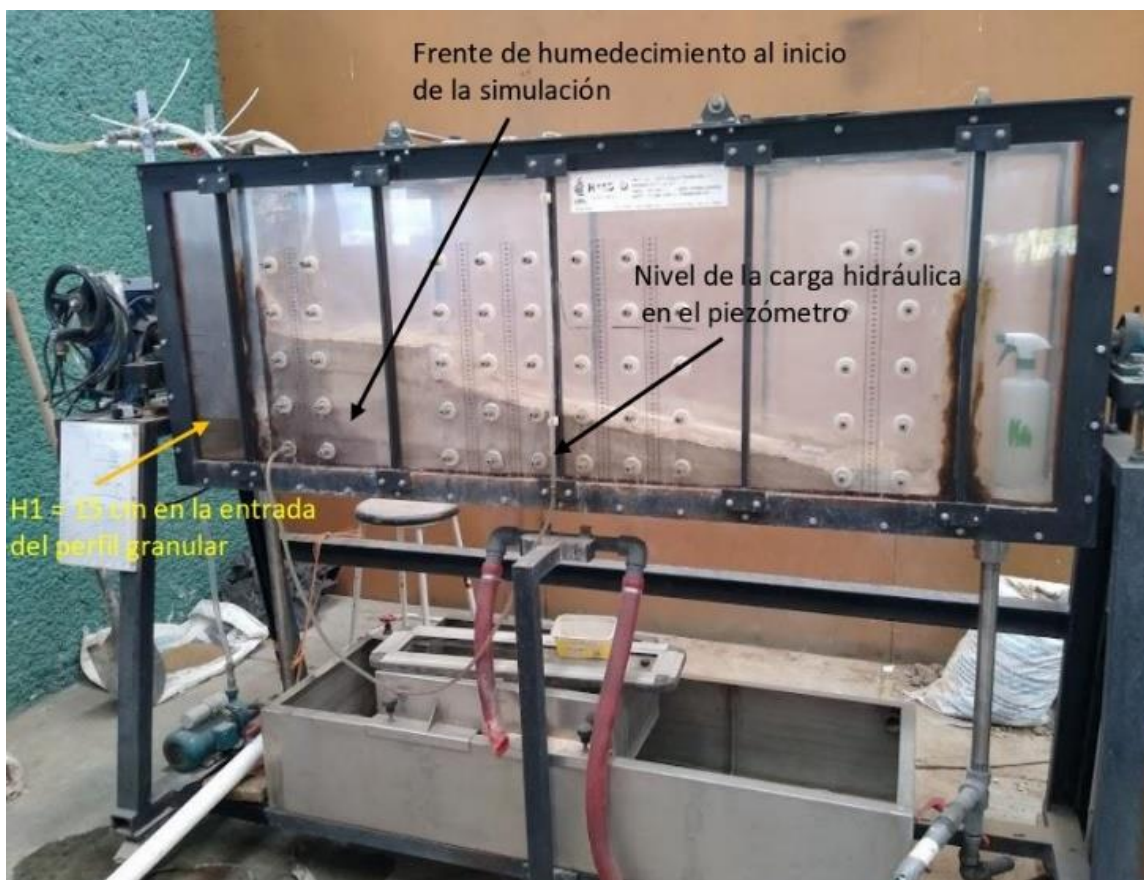
Figura 3. Detalle de la reproducción de la simulación con gradiente: H1 = 15\text{ cm} y H2 = 0.0\text{ cm} .
