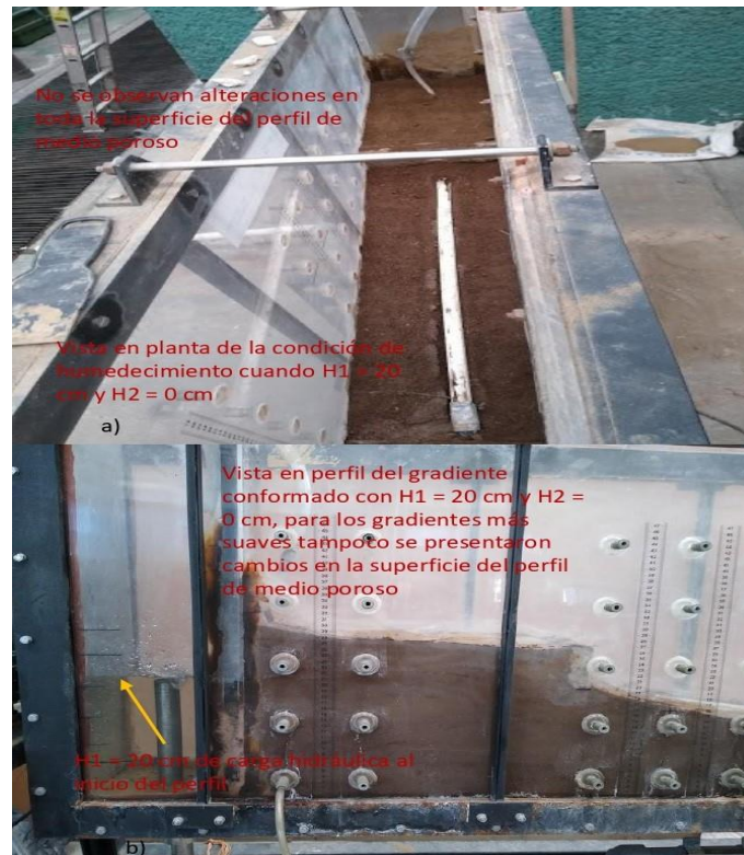
Figura 5. Detalle de la reproducción de la simulación con gradiente: H1 = 20 cm y H2 = 0.0 cm.
